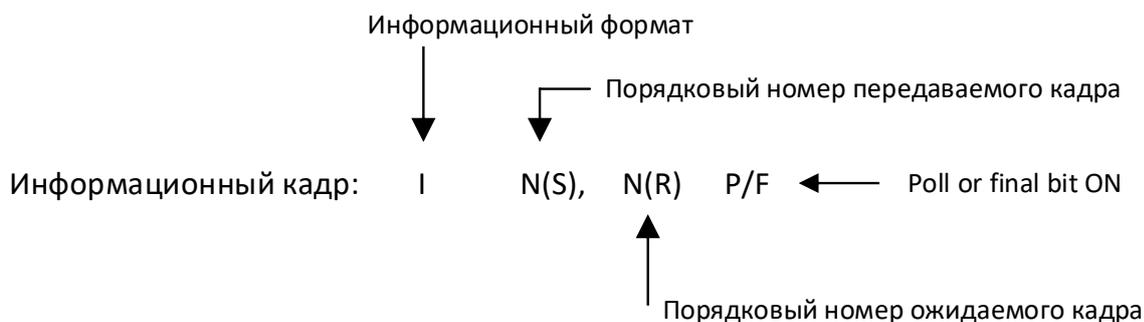
*Пример:* Pri xmits: I2,6 P. Эта запись обозначает информационный кадр первичной станции с порядковым номером передаваемого кадра 2 [ $N(S)=2$ ], ожидаемый I-кадр от вторичной станции с порядковым номером 6 [ $N(R)=6$ ] (подтвержденными считаются кадры с номером 5 и ниже), и бит опроса установлен в «1» (т.е. для запуска передачи с помощью I-кадров, если они имеются).
