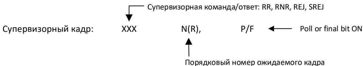
*Пример:* Pri xmits: RR2 P. Эта запись обозначает команду готовности к приему (RR), N (R) = 2 (то есть ожидаемый I-кадр от вторичного устройства - это номер последовательности приема 2); и бит опроса установлен в «1».
