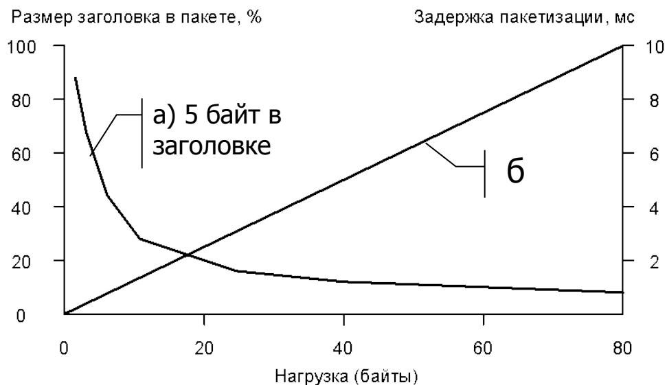
Зависимость процентной величины заголовка в пакете и задержки пакетизации от размера (числа байт) нагрузки при передаче речи со скоростью 64 кбит/с
