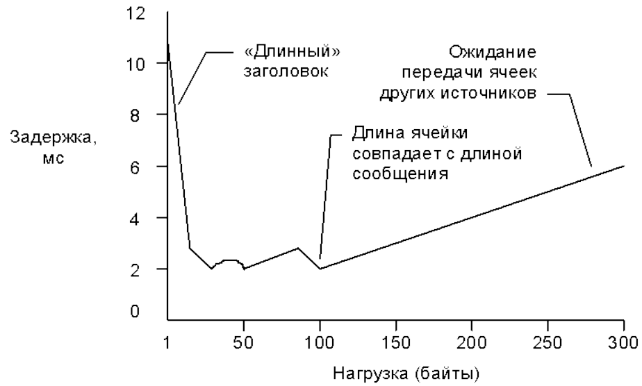
Задержка и изменение задержки малы для коротких сообщений, таких как отсчеты речевого сигнала
