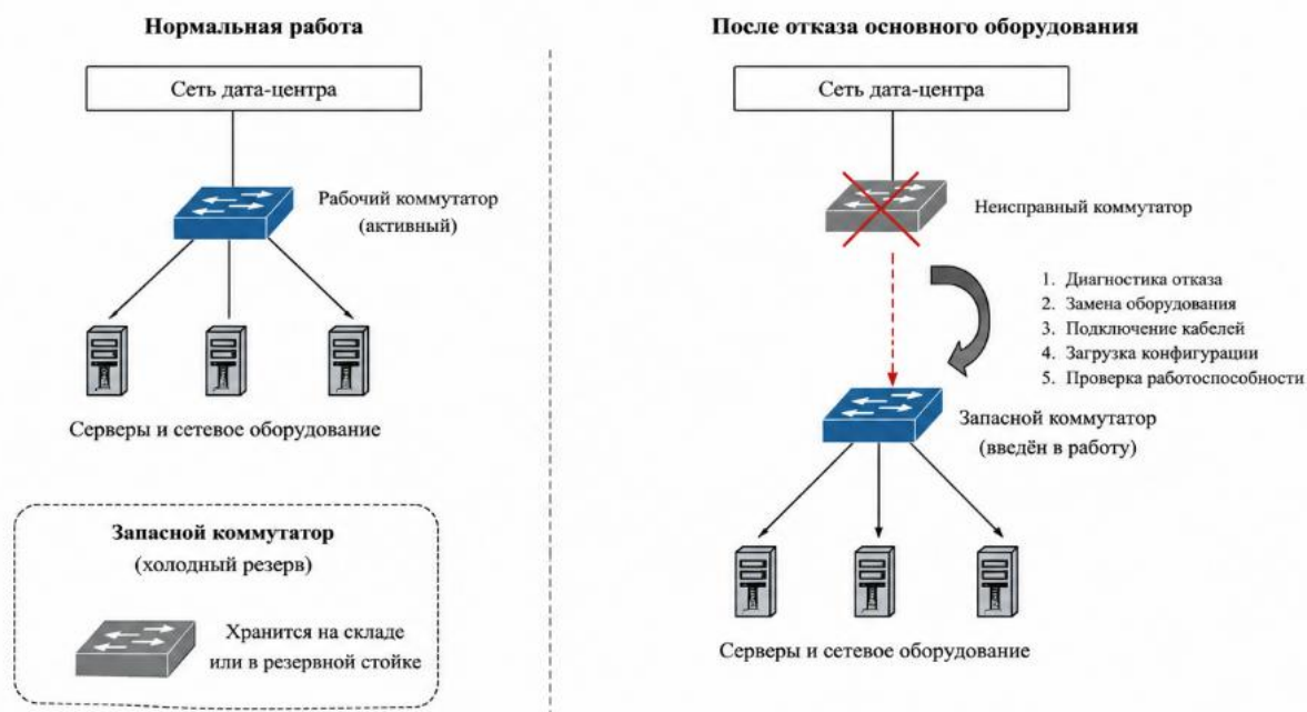
Рисунок 3 - Пример холодного резервирования сетевого оборудования
