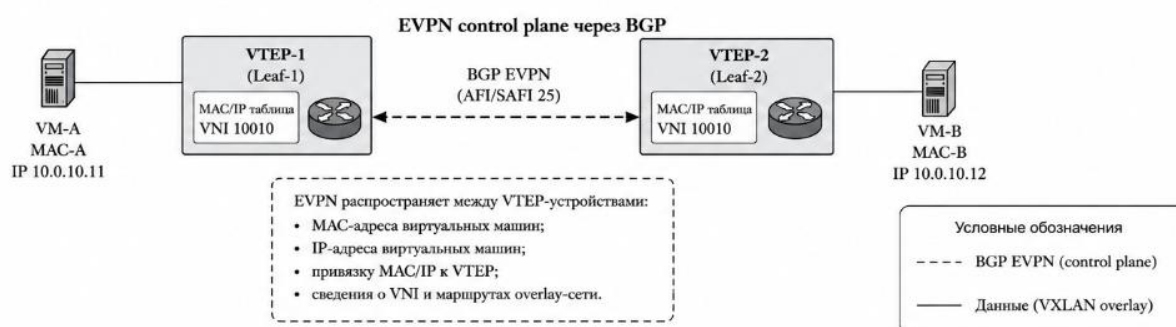
Рисунок 11 — Схема EVPN как control plane для VXLAN
